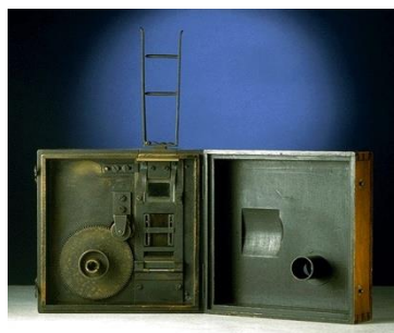
Joonis 5 Lumiere'de kaamera avatud korpusega
